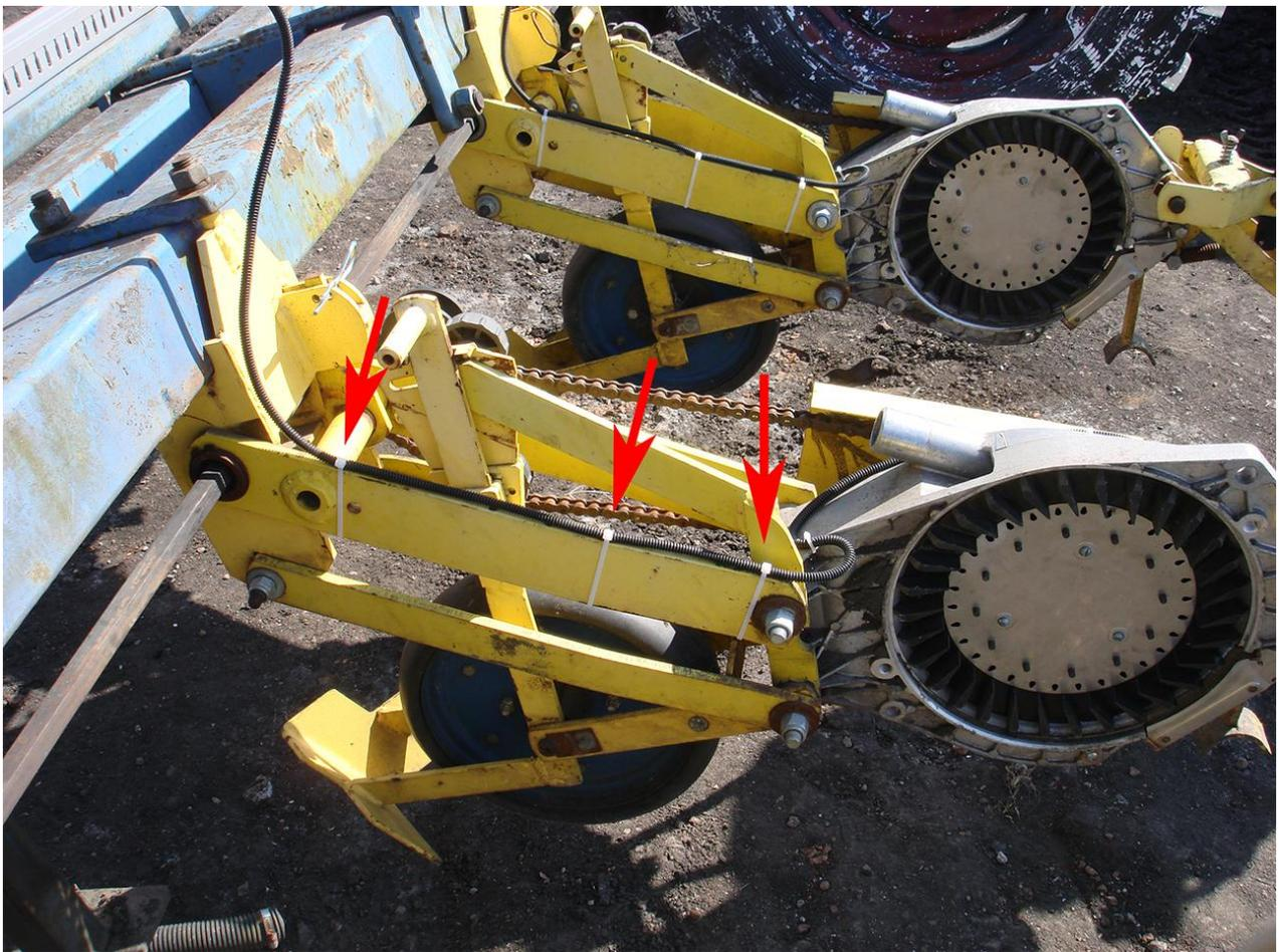
Рис.3.2 – Отбортовка проводки по высевающей секции
