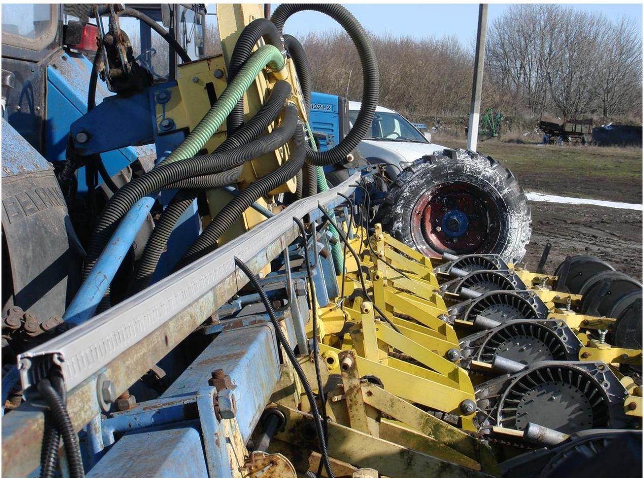
Рис.8 – Монтаж проводки на сеялке с использованием перфорированного короба 25×25мм
