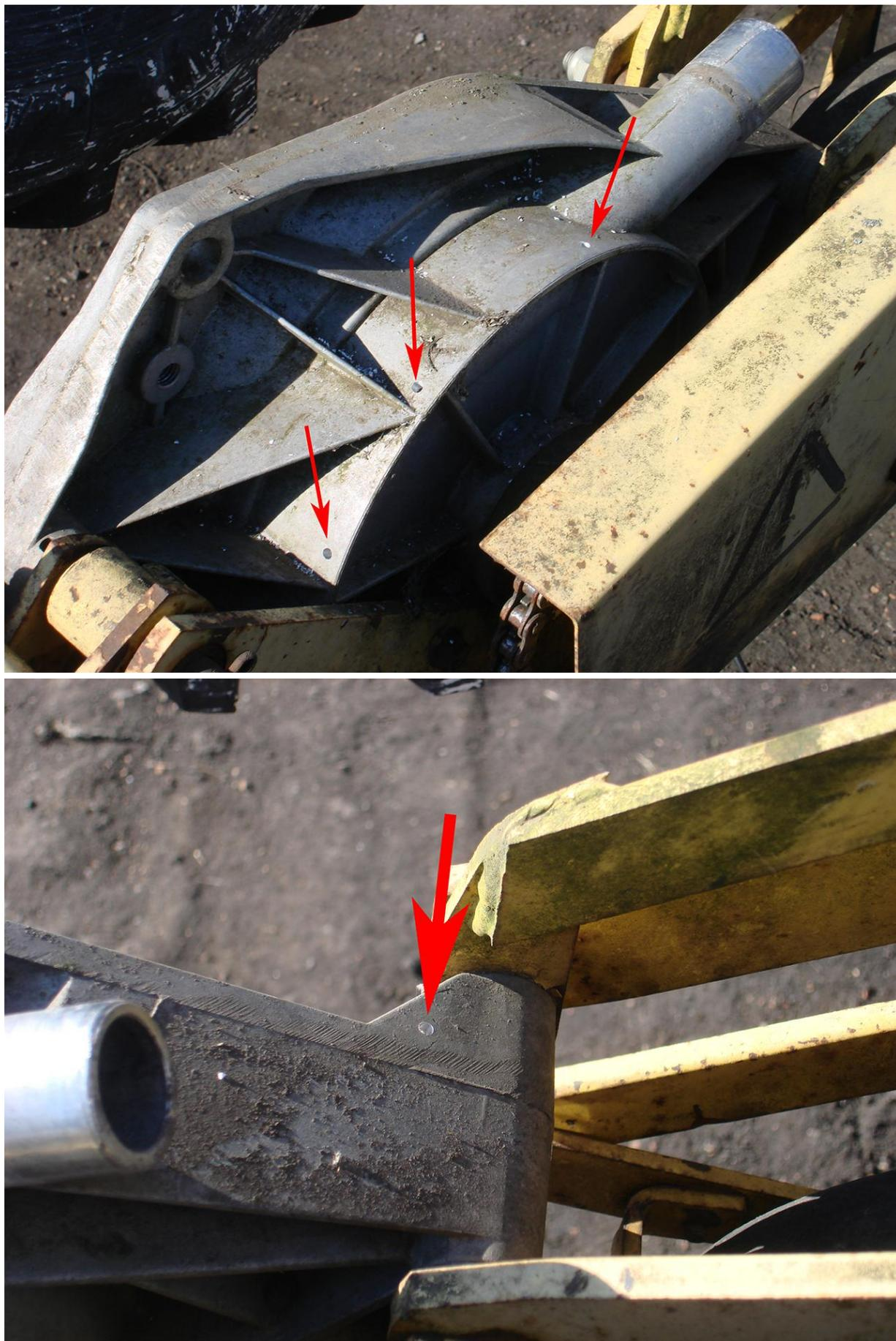
Рис.1 – Просверлить сквозные отверстия в ребрах корпуса высевающего для монтажа провода датчика высева. Диаметр отверстий 3,5мм.
