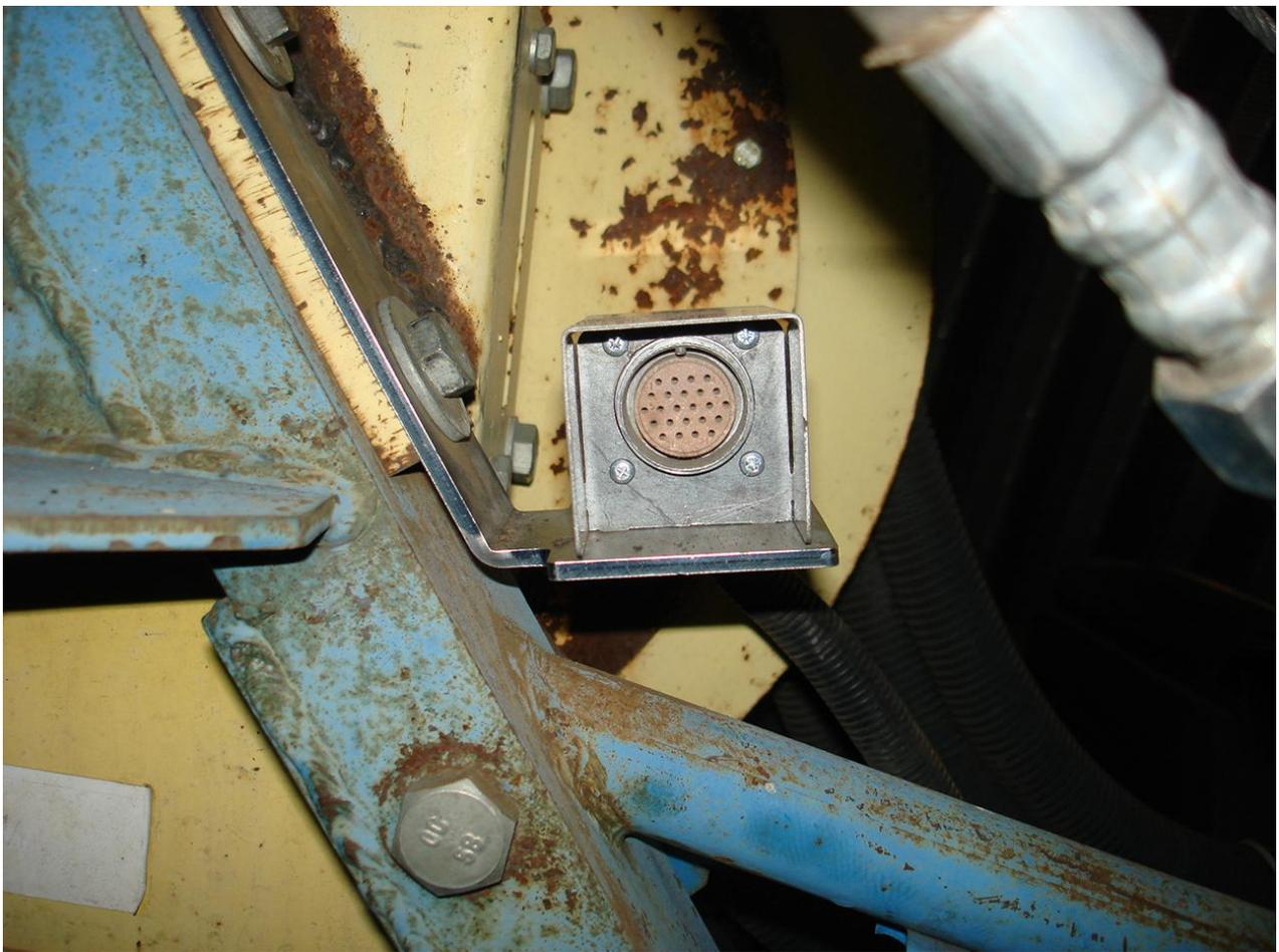
Рис.7 – Крепление разъема к кронштейну с использованием 4-х винтов М3 (использовано фото с другой сеялки, где кронштейн был с левой стороны)
