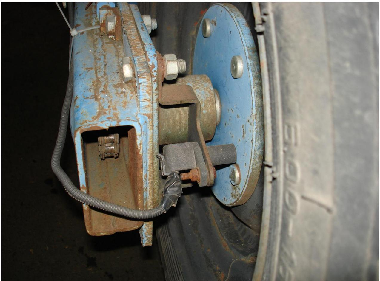
Рис.4 – Установка датчика пути на кронштейн
