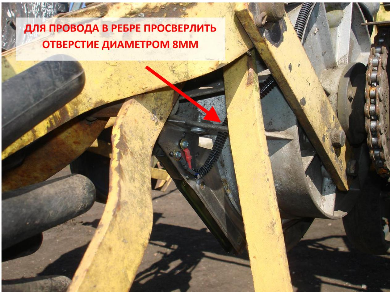
Рис.2 – Установка и подключение датчика высева.
