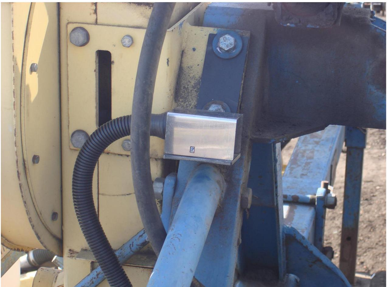
Рис.6 – Установка кронштейна разъема на сеялку
