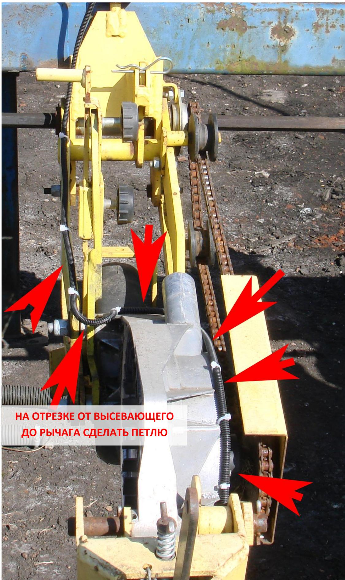
Рис.3.1 – Отбортовка проводки по высевающей секции
