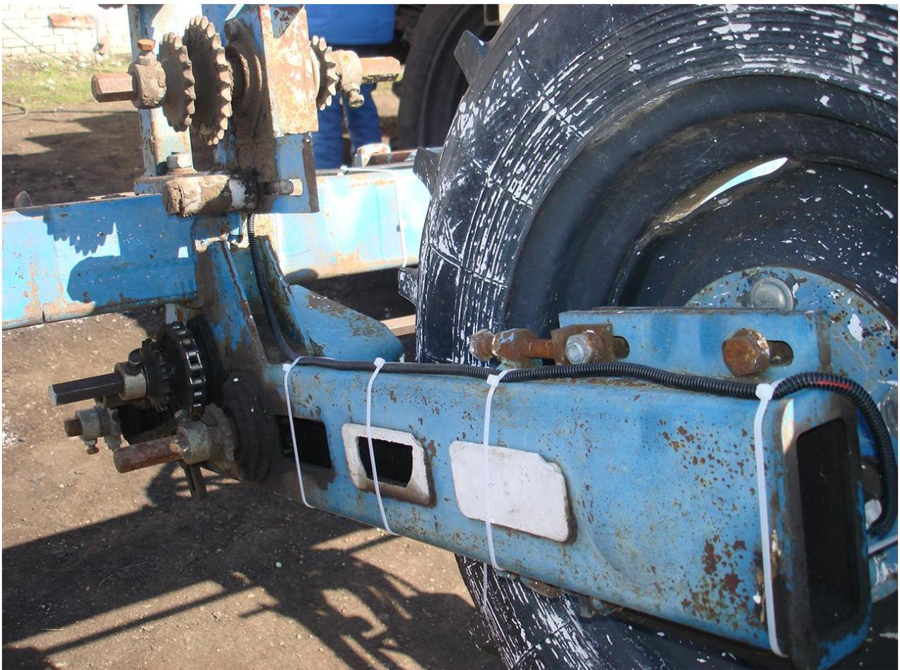
Рис.5 – Отбортовка провода датчика пути
